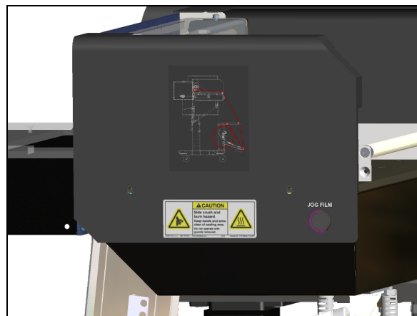
Rysunek 2-3A. Naklejka wstęgi i przycisk Jog.
