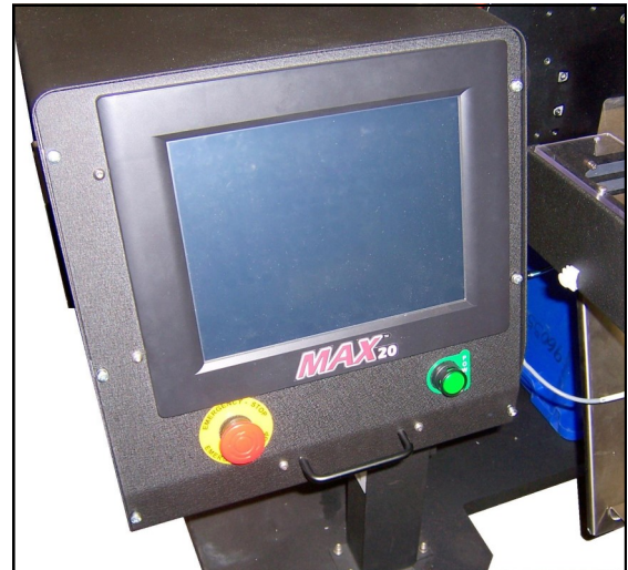
Rysunek 5-1A. Przyciski zatrzymania awaryjnego i zasilania.
